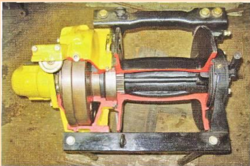
Устройство лебедка с волновым зубчатым редуктором и гидроприводом
