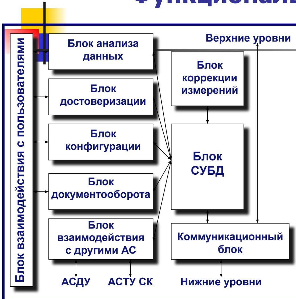
**Коммуникационный блок** - сбор и передача данных КУ и дополнительной информации
