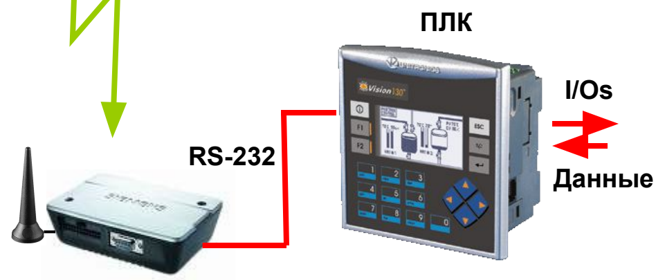
GPRS-модем и встроенное приложение для модема
