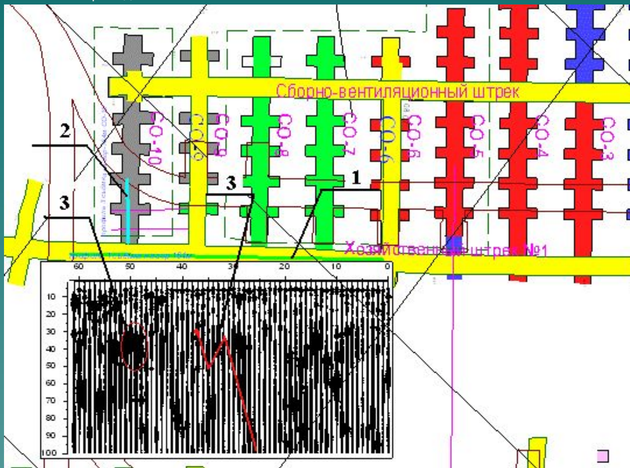
Рис. 1.Фактический результат трещиноватости в массиве этажей гор.-164/ -215м., выполненный методом спектрально-сейсморазведочного профилирования. 1 – профиль №1; 2 - профиль№2; 3 – зона повешенной трещиноватости массива
