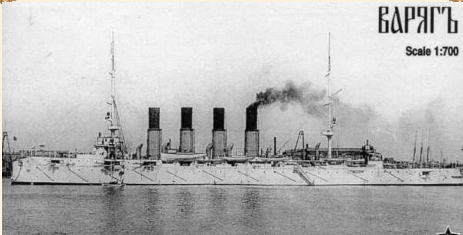
**«Варяг» - новый четырёхтрубный крейсер водоизмещением 6500 тонн. Крейсер имел 6 торпедных аппаратов.**
