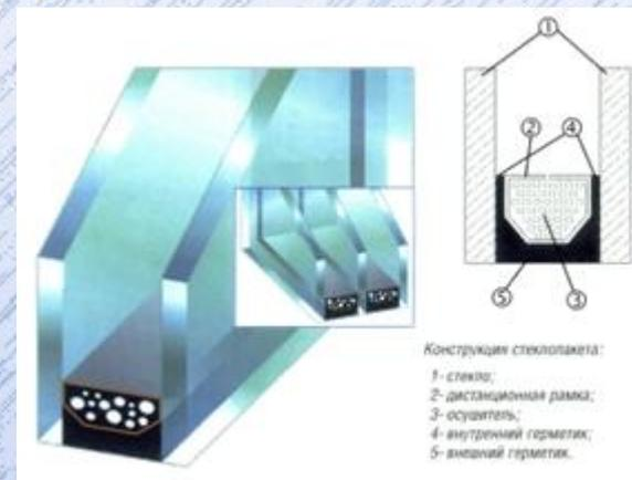
В зависимости от числа камер **стеклопакеты** делятся на **однокамерные** и **двухкамерные**.
