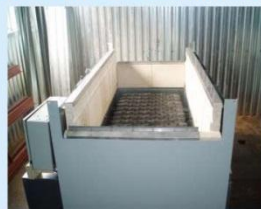
Нижняя часть котла с блоком горелок и блоком автоматики
