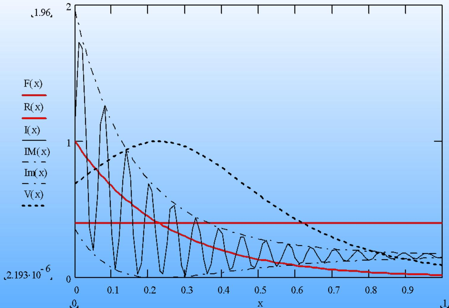
Рис.3.3. Интерференция сигнального ( $F(x)$ ) и опорного ( $R(x)$ ) пучков в плоскости Фурье-голограммы. Пунктирная линия – видность интерференционной картины.
