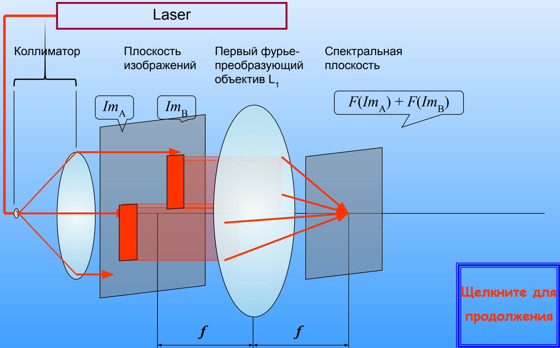
В задней фокальной плоскости объектива для формирования изображения спектров на экране перед объективом в плоскости  $Im_A$  этих изображений объектив объектив освещаются когерентной волной, а спектры формируются в одной и той же области, то спектры интерферируют. Картины интерференции двух спектров иногда называют совместным спектром.
