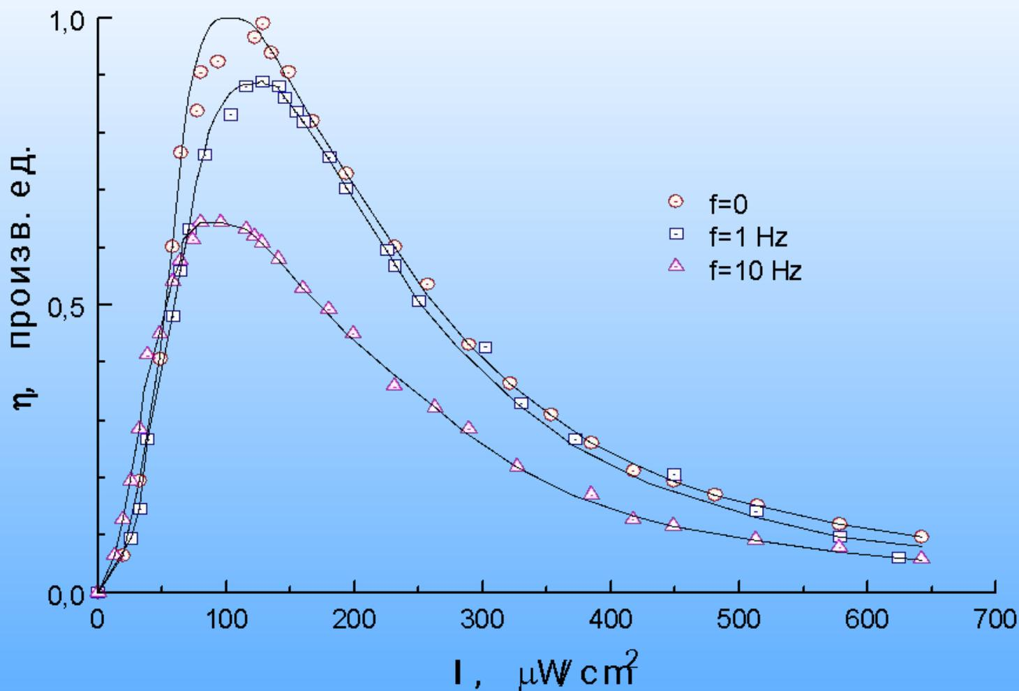
Рис.3.2. Зависимости дифракционной эффективности от интенсивности записывающего излучения при питании структур халькогенидный стеклообразный полупроводник –нематический жидкий кристалл постоянным напряжением и импульсами с частотами 1 и 10 Hz. (А.Н.Чайка и др., Письма в ЖТФ)
