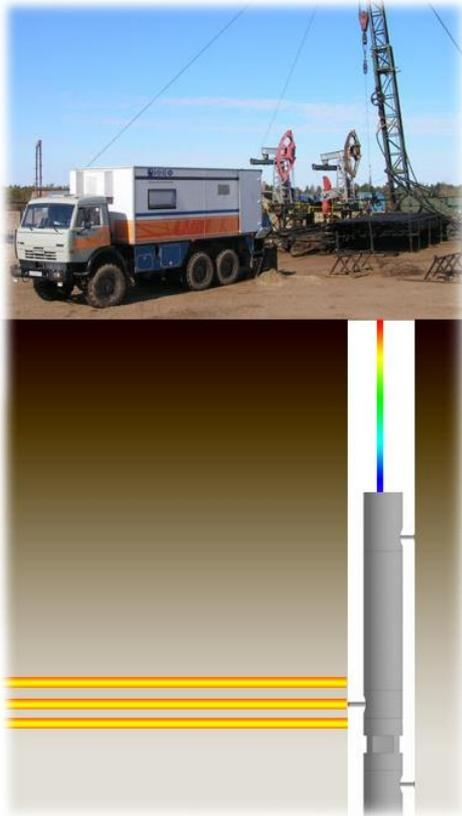
Предназначен для ГДК и опробования пластов в нефтяных и газовых скважинах.
