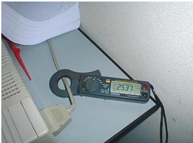
Ток по интерфейсному принтерному кабелю параллельного (LPT) порта
