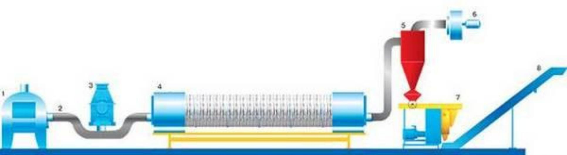
1. Теплогенератор; 2. Материалопровод; 3. Дробилка молотковая;
