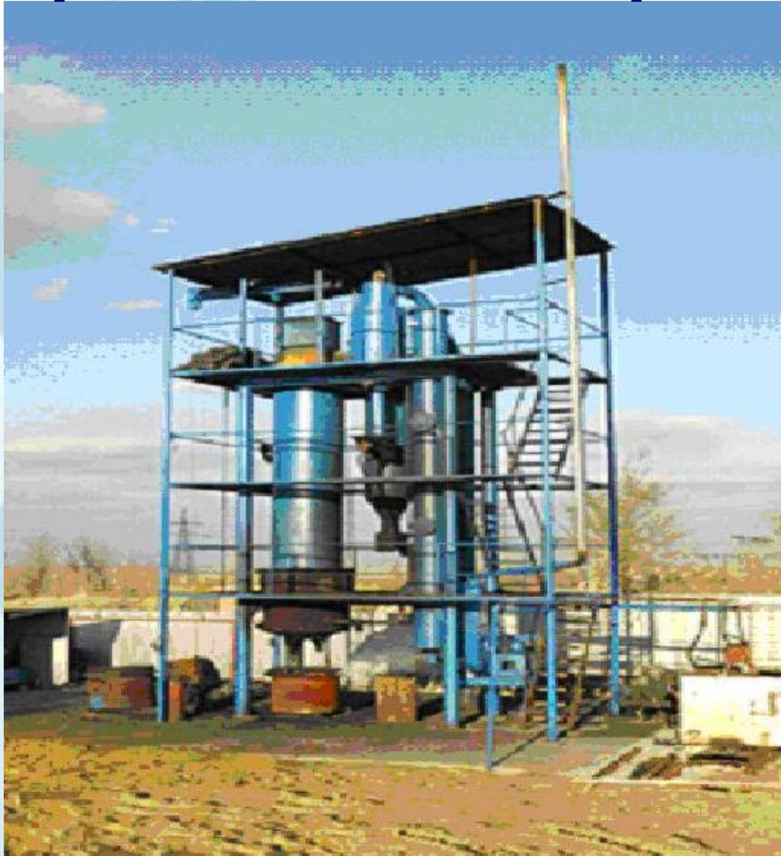
**Установка пиролизная для утилизации и переработки отслуживших резинотехнических изделий и пластмасс методом пиролиза в жидкое, газообразное и твёрдое топливо**
