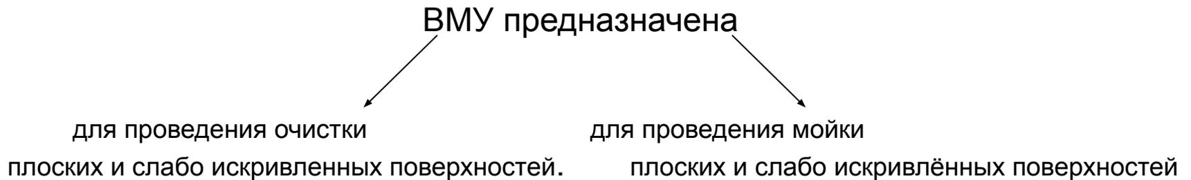
Основной принцип ВМУ - создание вихревого движения воздуха над участком обрабатываемой поверхности, покрытой вихревой моющей головкой, имеющей быстровращающуюся, щетку-активатор, подача в эту зону моющей жидкости и последующий полный отбор продуктов мойки в утилизирующую емкость. Вместе с продуктами мойки установка интенсивно удаляет и летучие составляющие, обеспечивая чистоту атмосферы на участке мойки.
