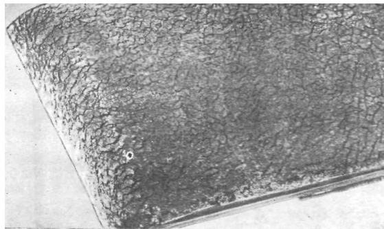
Внешний вид заготовки с чешуйчатостью
