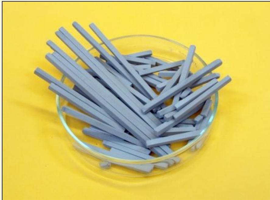
Разработана методика изготовления керметов с мезопористыми компонентами и их прекурсорами, включающая смешение порошкообразных продуктов, загрузку их в пресс-форму, виброуплотнение, гидротермальную обработку, сушку и прокаливание. Образец кермета, изготовленного из порошкообразного алюминия марки АСД-1 и прекурсора мезопористого оксида алюминия – аморфного продукта ЦТА.
