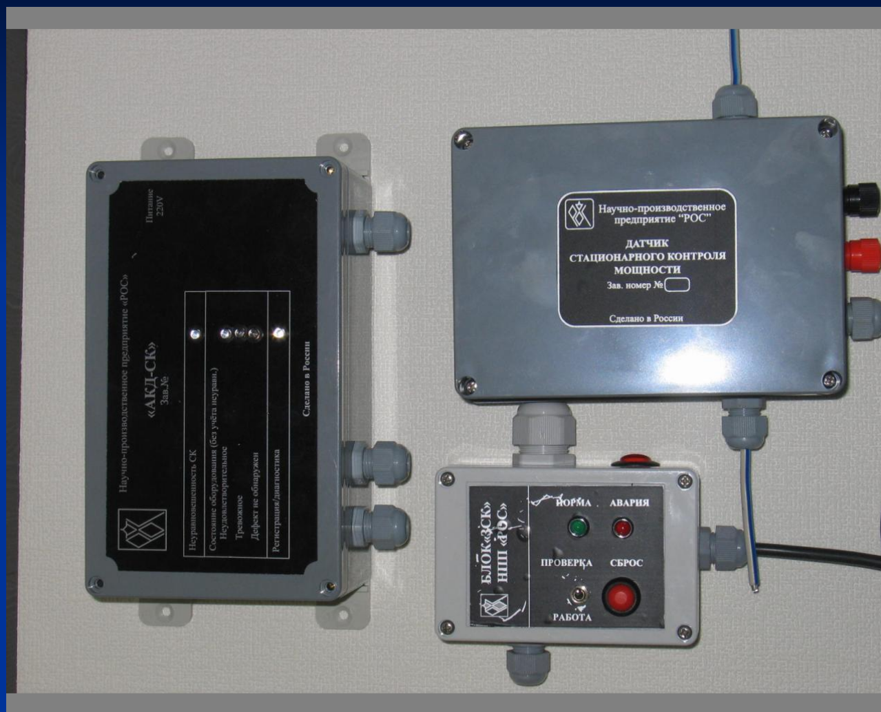
Контроллер «АКД-СК», датчик «СКМ» и модуль «ЗСК»
