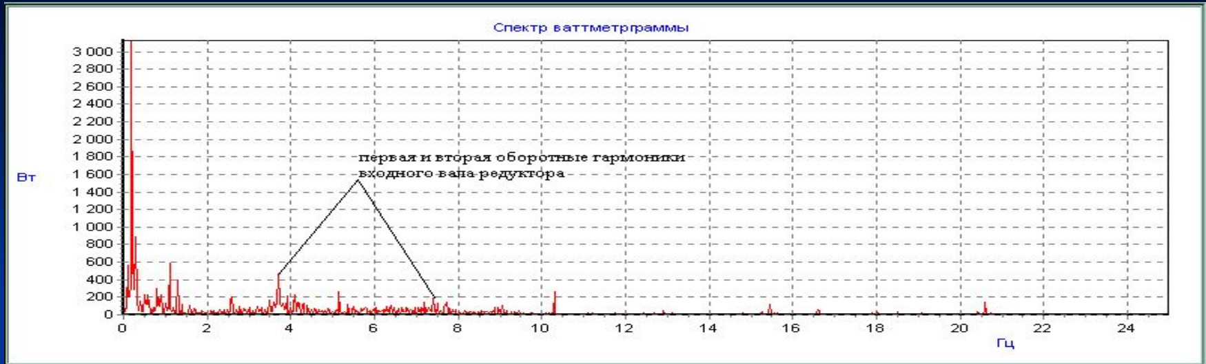
Дефект входного вала редуктора
