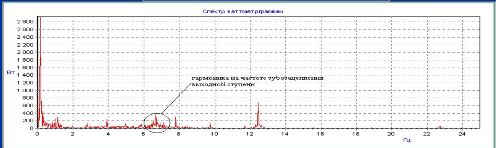
Дефект шестерни выходной ступени редуктора
