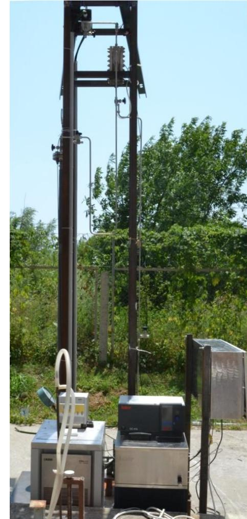
На основе разработанной конструкторской документации совместно с НПО «Технефтегаз» изготовлены необходимые технологические аппараты и проведены сборочно-монтажные работы ректификационной лабораторной установки.
