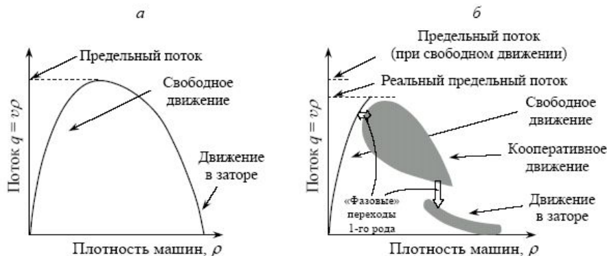
Рис. 1. Фундаментальная диаграмма (а) и фазовые состояния автотранспортного потока (б)
