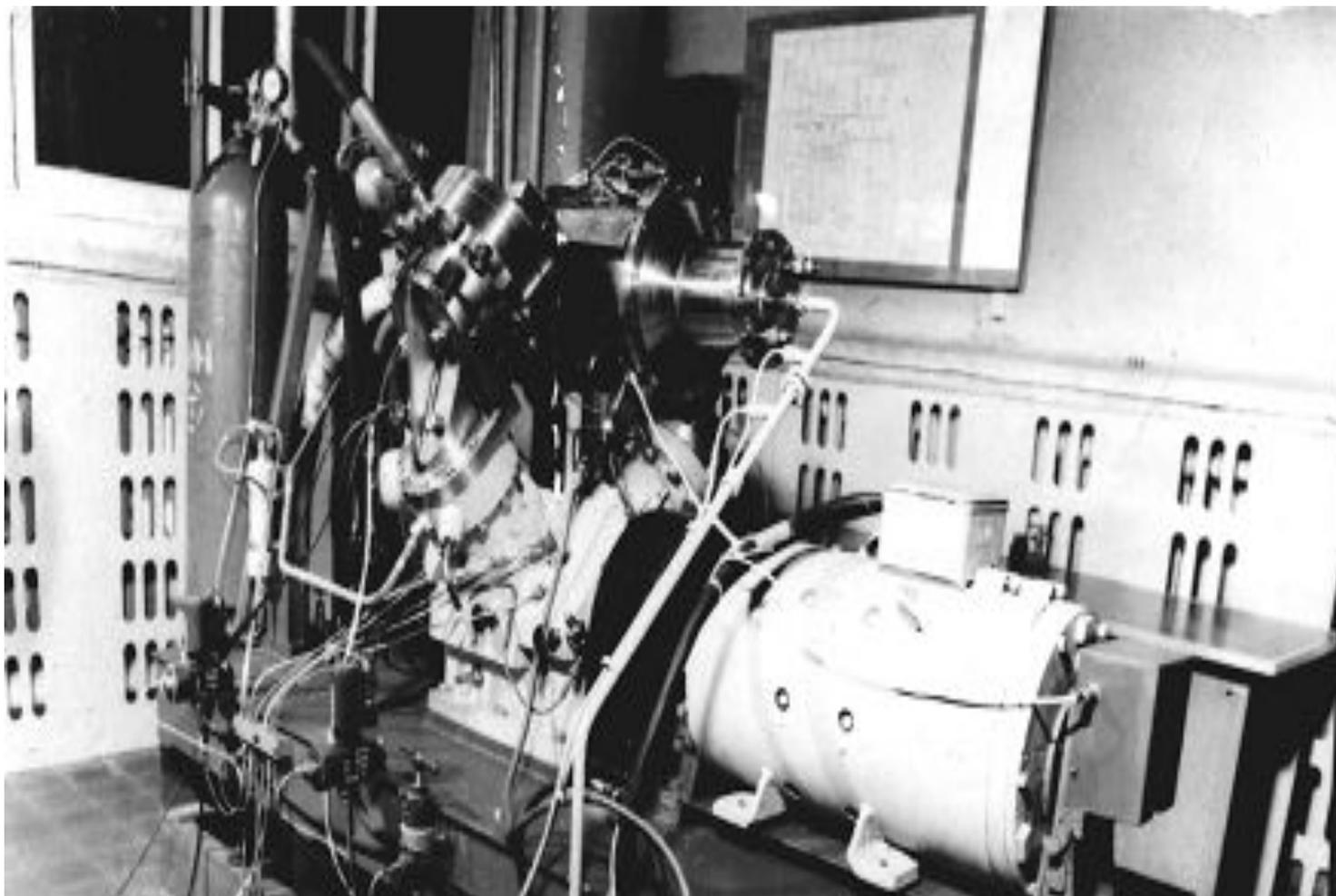
**Двигатель Стирлинга двойного действия с бесшатунным механизмом
