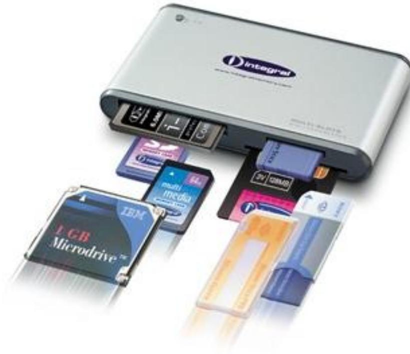
**Картридер** – устройство для чтения/записи информации на карты памяти. Картридеры отличаются по скоростным характеристикам чтения/записи информации. Картридеры бывают встроенными в системный блок или конструктивно независимые, подключаемые к системному блоку через USB-порт.
