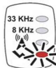
На застроенной территории, где много блуждающих токов, металлические трубопроводы неглубокого заложения (например, водопровод), также создают вокруг себя магнитные поля и могут быть обнаружены пассивным способом.
