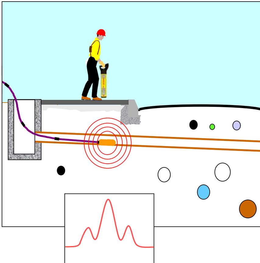
DIGIMOUSE™ испускает пиковый сигнал и ложный сигнал к концу каждого пика
