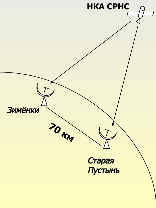
Радиотелескопы РТ-14 и РТ-15 оборудованы приёмными системами в диапазонах **327 МГц, 610 МГц, 1660 МГц.**
