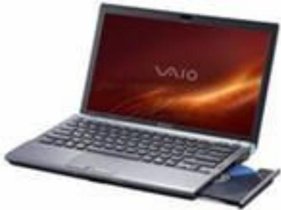
НОУТБУК (англ. notebook — записная книжка), портативный микрокомпьютер, внешние и внутренние устройства которого выполнены в одном корпусе, обычно в виде чемоданчика, весом от двух до пяти килограммов. Электропитание ноутбука осуществляется с помощью аккумуляторных батарей.
