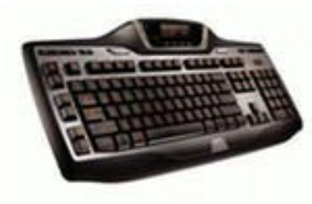
Клавиатура IBM PC предназначена для ввода в компьютер информации от пользователя. Расположение латинских букв на клавиатуре IBM PC, как правило, такое же, как на английской пишущей машинке, а букв кириллицы - как на русской пишущей машинке.
