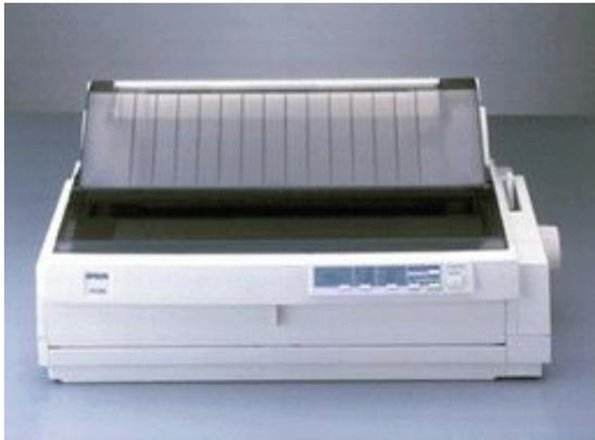
Существуют модели принтеров как с широкой (A3), так и с узкой (A4) кареткой. Скорость печати для высокопроизводительных моделей может составлять до 380 знаков в секунду. Более высокую производительность обеспечивают построчные (постраничные) матричные принтеры. Вместо маленьких точечно-матричных головок они используют длинные массивы с большим количеством игл при этом достигается скорость порядка 1500 строк в минуту. Матричные ударные печатающие устройства создают много шума.
