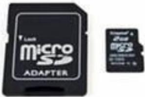
Флеш-память — разновидность полупроводниковой технологии электрически перепрограммируемой памяти. Это же слово используется в электронной схемотехнике для обозначения технологически законченных решений постоянных запоминающих устройств в виде микросхем на базе этой полупроводниковой технологии. В быту это словосочетание закрепилось за широким классом твердотельных устройств хранения информации.
