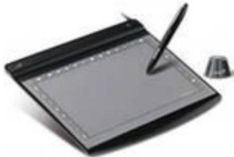
Графический планшет позволяет создавать рисунки так же, как и на листе бумаги. С помощью специального пера на поверхности планшета создается рисунок.
