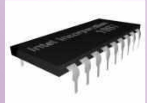
Одна ИС способна заменить тысячи транзисторов, т.е. один крошечный кристалл обладает такими же вычислительными возможностями, как и 30-тонный Эниак! Быстродействие ЭВМ третьего поколения возросло в 100 раз, а габариты значительно уменьшились.
