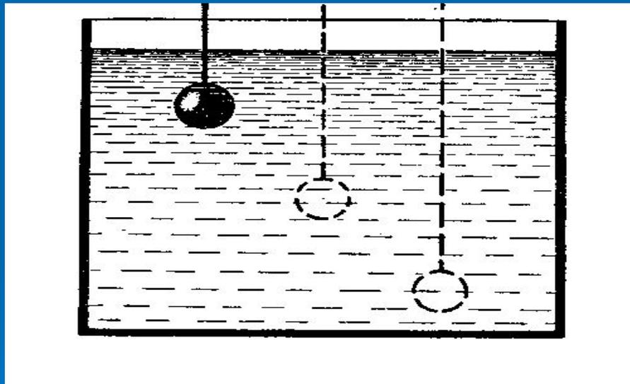
Изменится ли архимедова сила, если брусок, находящийся в жидкости, перевести из положения а в положение б?
