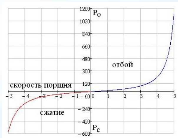
Зависимость сил сопротивления амортизатора от скорости перемещения поршня на ходах сжатия и отбоя
