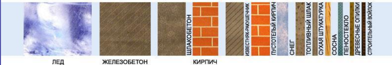
ШКАЛА ТОЛЩИНЫ МАТЕРИАЛОВ ПРИ ОДИНАКОВОЙ ТЕПЛОПРОВОДНОСТИ
