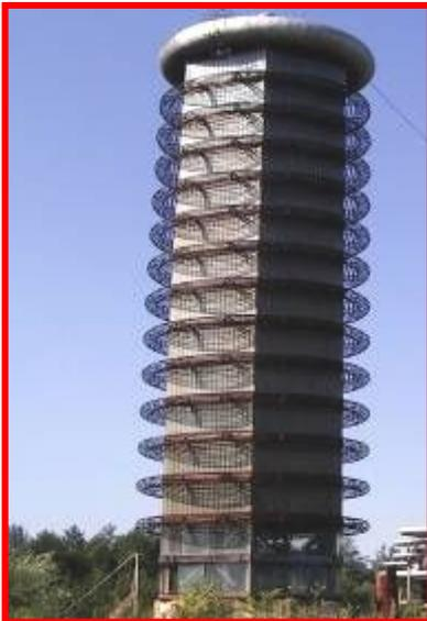
**Генератор импульсного напряжения на 10МВ**
