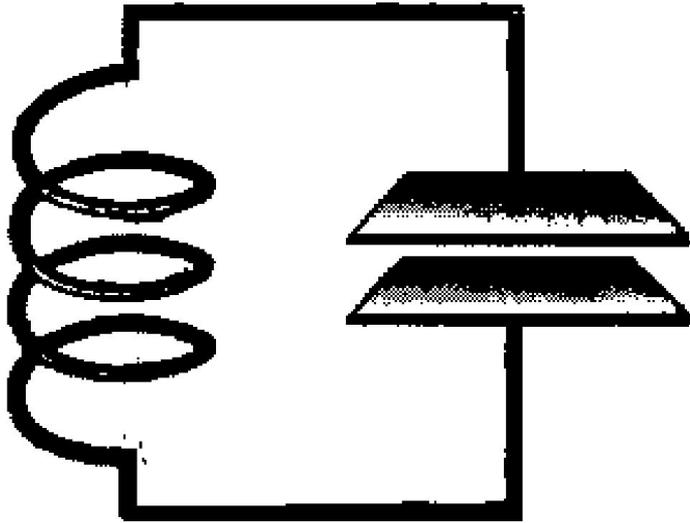
Система колебательного контура
