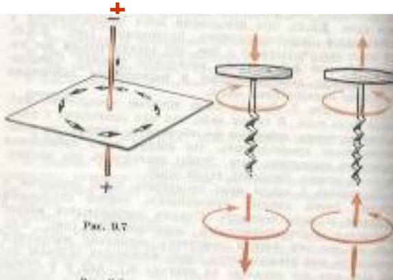
Прямой проводник: если поступательное движение буравчика совпадает с направлением тока, то вращательное движение его ручки совпадает с направлением магнитных линий магнитного поля тока.
