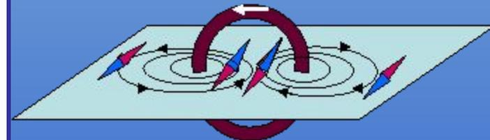
Направление магнитных линий связано с направлением тока в проводнике
