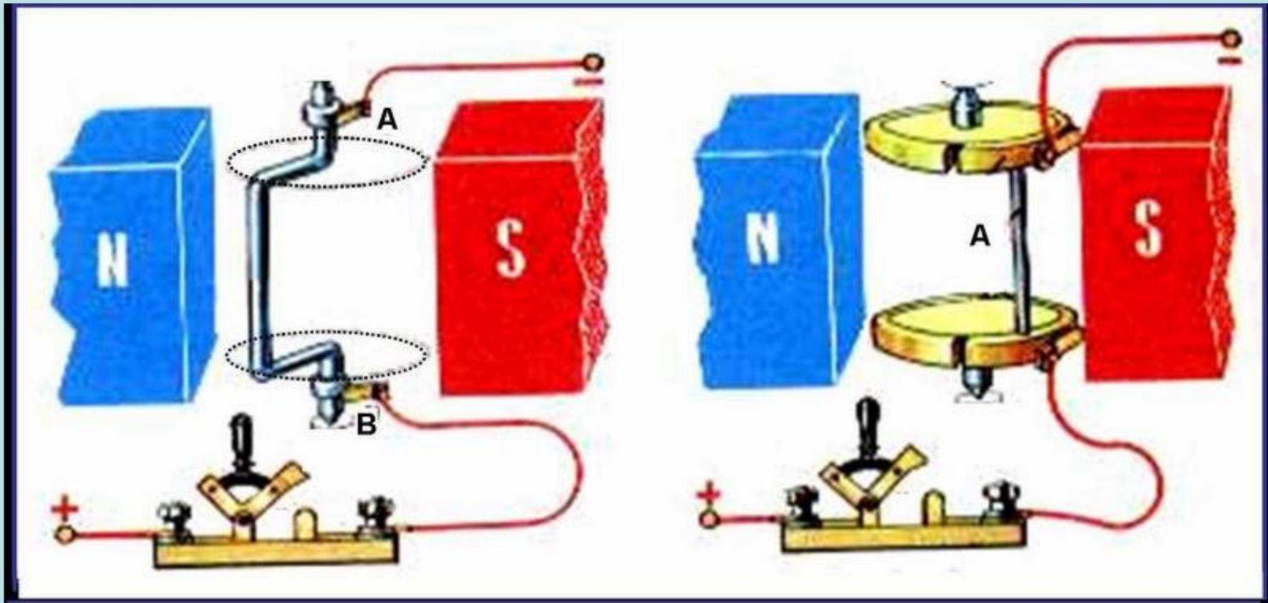
Между полюсами магнита находится  $\Gamma$ -образный проводник. К концам проводника прижаты контакты – щётки **A** и **B**. Опишите, что будет происходить с проводником.
