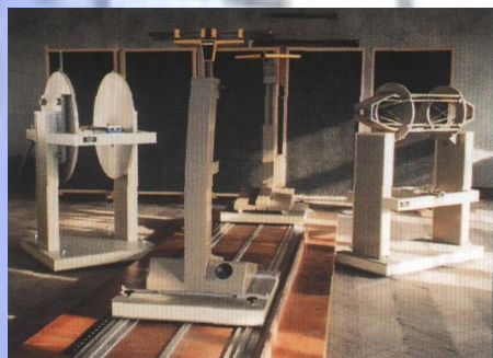
Государственный первичный эталон единицы напряженности электрического поля
