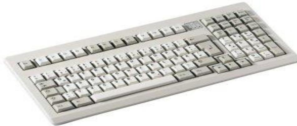
*Клавиатура является универсальным устройством ввода информации. По внешнему виду напоминает печатную машинку. Она позволяет вводить числовую и текстовую информацию.*
