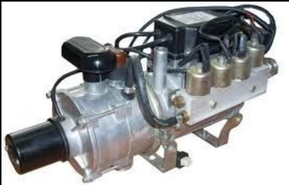
Подогреватель предпусковой газовой 15ТСГ, предназначен для разогрева двигателя с жидкостной системой охлаждения, работающего на компримированном природном газе при температуре окружающего воздуха до минус 45°С.
