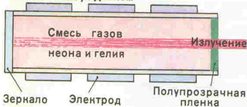
Газовый лазер с электрическим возбуждением
