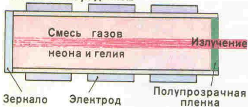
Газовый лазер с электрическим возбуждением
