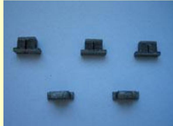
2. Заготовки полупроводниковых термоэлектрических элементов (BiSb)
