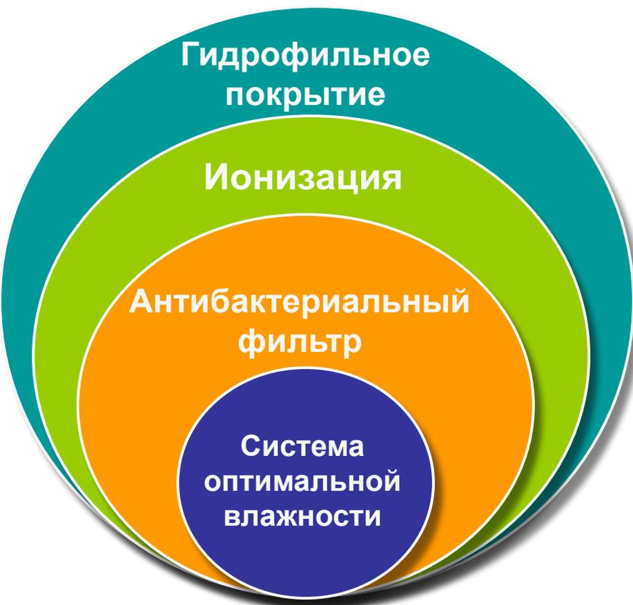
Для внутреннего блока увеличивает эффективность охлаждения, позволяя конденсируемым каплям воды спокойно стекать. Для внешнего блока увеличивает эффективность нагрева, способствуя ускорению процессов оттаивания (разморозки).
