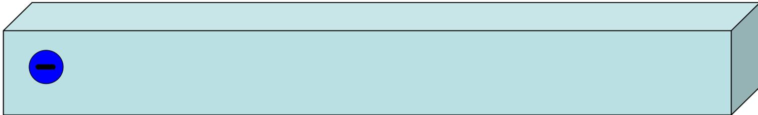
**Электроны сталкиваются с кристаллической решеткой и теряют свою кинетическую энергию, которая идет на нагрев решетки. Поэтому возникает электрическое сопротивление.**
