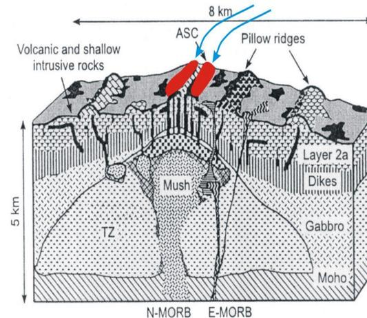
Рис. 6.6. Строение океанической коры участка  $9^{\circ}31'$  (см. рис. 6.5) с учетом модели магматической камеры, представленной в работе [Sinton, Detrick, 1992]. Показано сложное асимметричное распределение лав, даек и силлов вне осевой кальдеры (ASC). Часть лав происходит из промежуточной зоны (TZ) или в результате смешения с глубинными расплавами типа E-MORB [Perfit et al., 1994].
