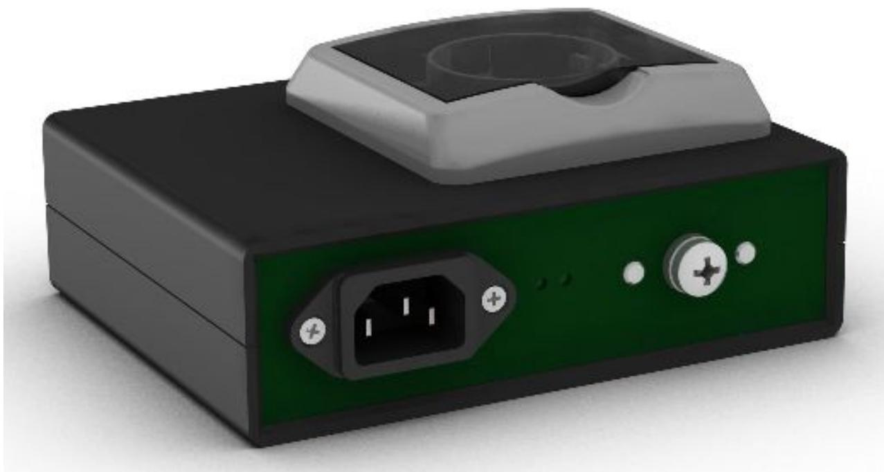
Импульсные перенапряжения (варисторы) + фильтр ВЧ помех + токовая перегрузка (полимерные позисторы). Для электросети ~220В.
