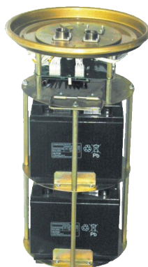
Резервный блок питания
