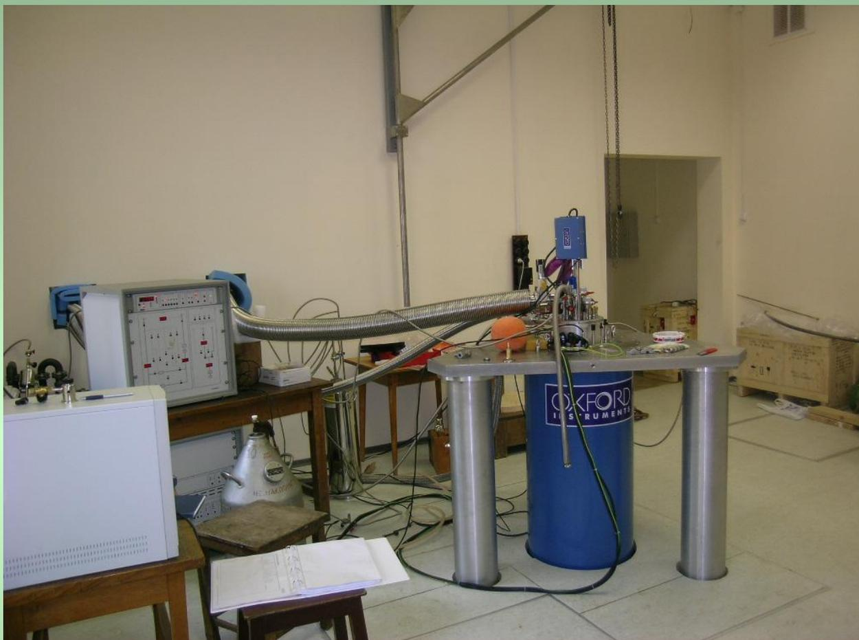
Общий вид установки KELVINOX-400, размещенной в ИФП РАН им. П.Л. Капицы. Установка позволяет получать температуры вплоть до 7 милликельвин с холодопроизводительностью 400 микроватт при температуре 100 милликельвин.
