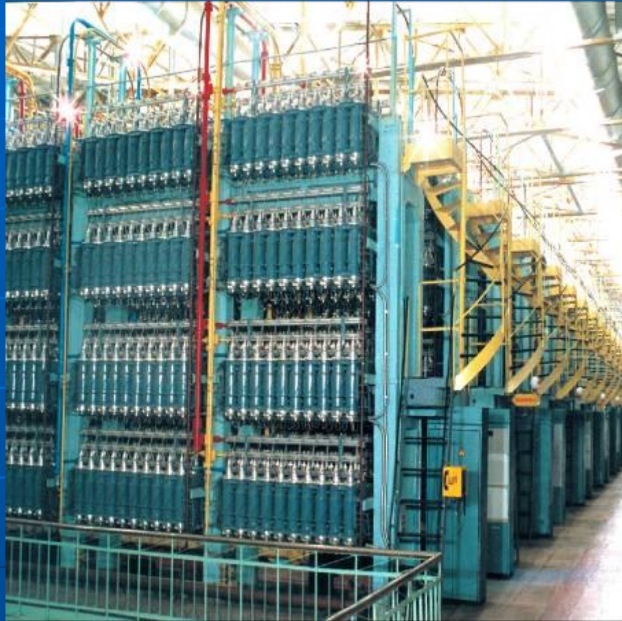
Внешний вид каскада разделительных центрифуг
