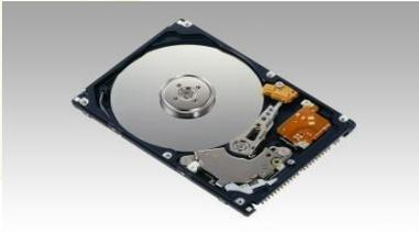
*Жесткий диск* — основное устройство для долговременного хранения больших объемов данных и программ. На самом деле это не один диск, а группа основных дисков, имеющих магнитное покрытие и вращающихся с высокой скоростью. Таким образом, этот «диск» имеет не две поверхности.
