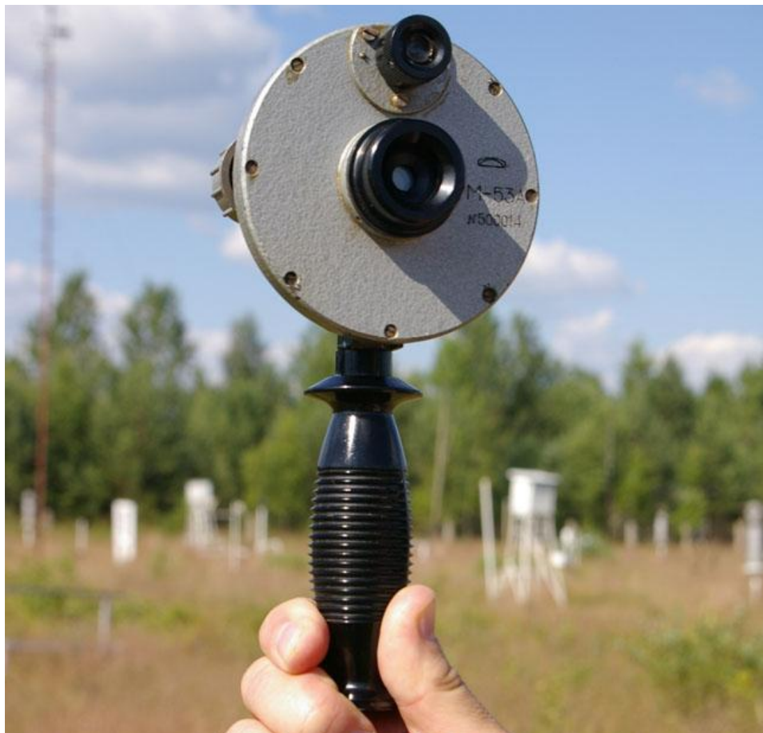
Рис. 6.3.2. Поляризационный измеритель дальности видимости М-53а
