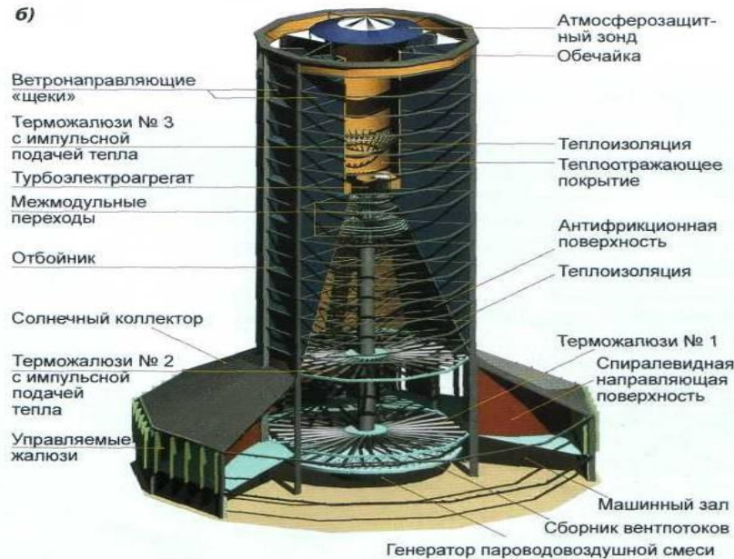
Центральная часть ГАБТЭС, где создается вихревой поток, снаружи (а) и в разрезе (б)
