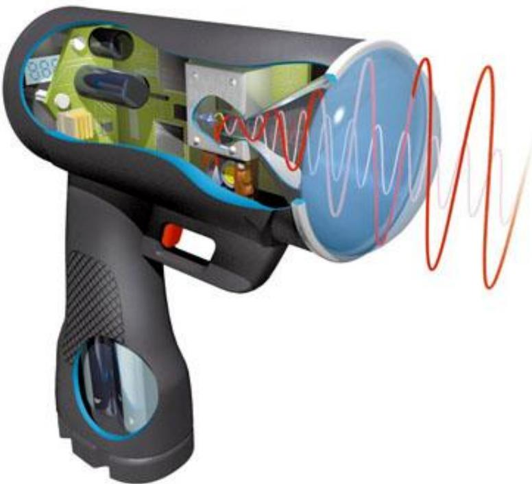
Лазерная “пушка”, излучающая очень узкий (1 м на длине 300 м) пучок инфракрасного света с длиной волны около 1 мкм, способна определять скорость **одной** машины, двигающейся в потоке. **Туман, дождь и снег мешают** работе лазерной пушки.
