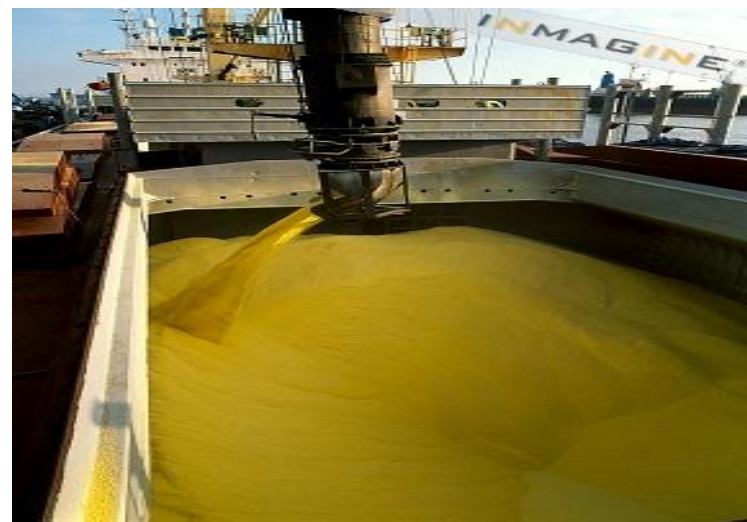
Загрузка гранулированной серы в морское судно
