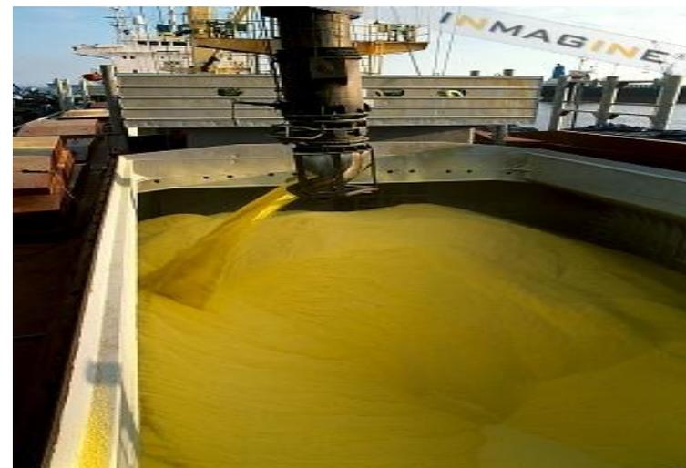
Загрузка гранулированной серы в морское судно
