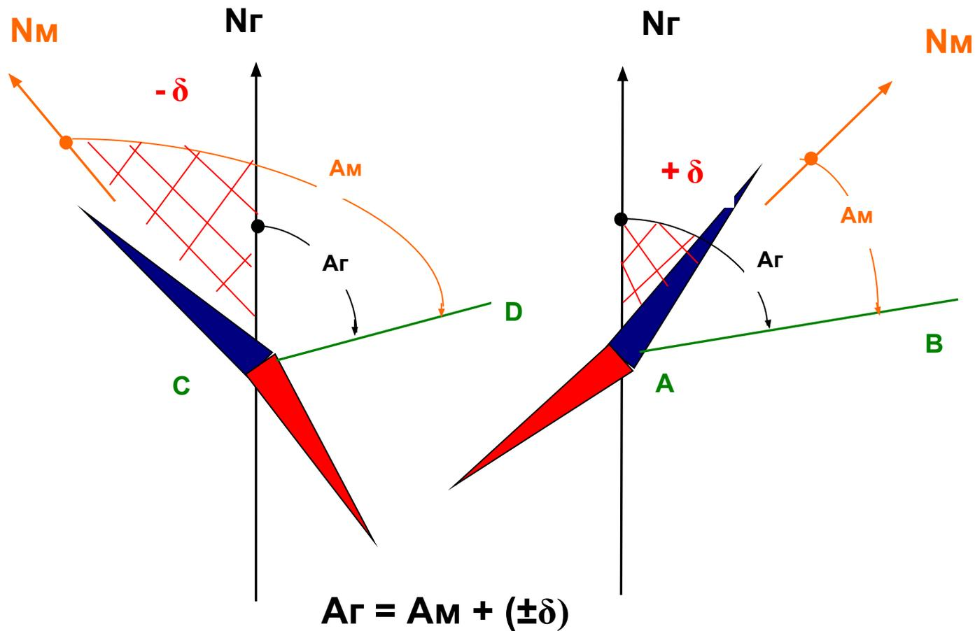
Рис. 5 – Магнитный азимут и магнитный румб
