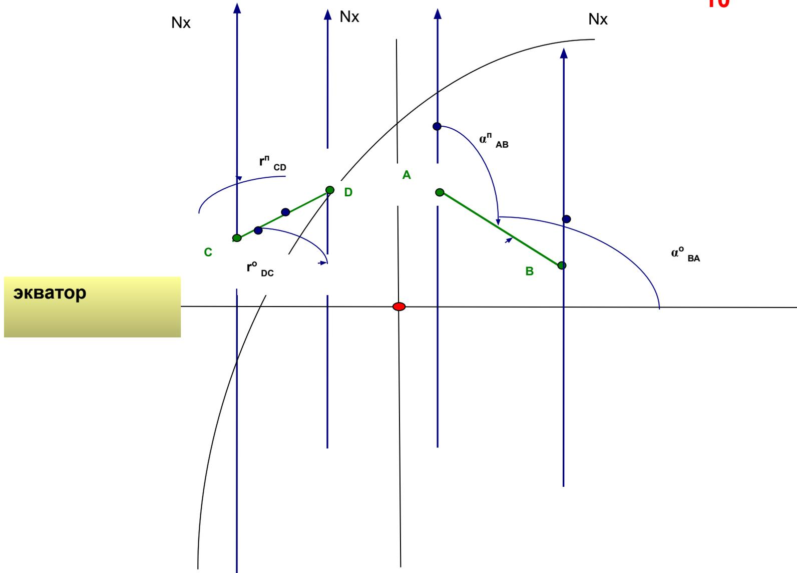
Рис. 3 – Углы ориентирования в прямоугольной системе координат
