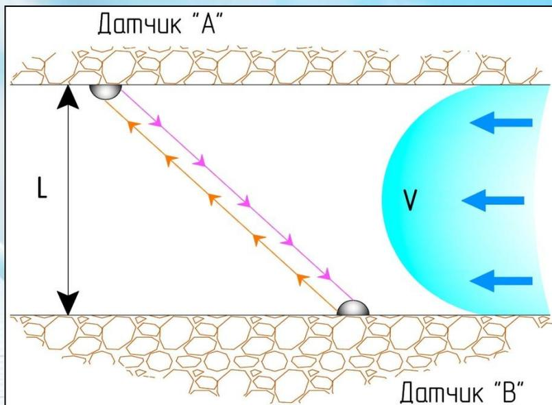
$T_{AB}$  – Время прохождения ультразвукового сигнала против потока (от датчика «А» к датчику «В»)
