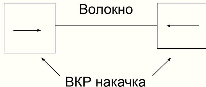
Основное преимущество ВКР накачки перед сосредоточенными усилителями – более равномерное распределение мощности, лучшее соотношение сигнал/шум
