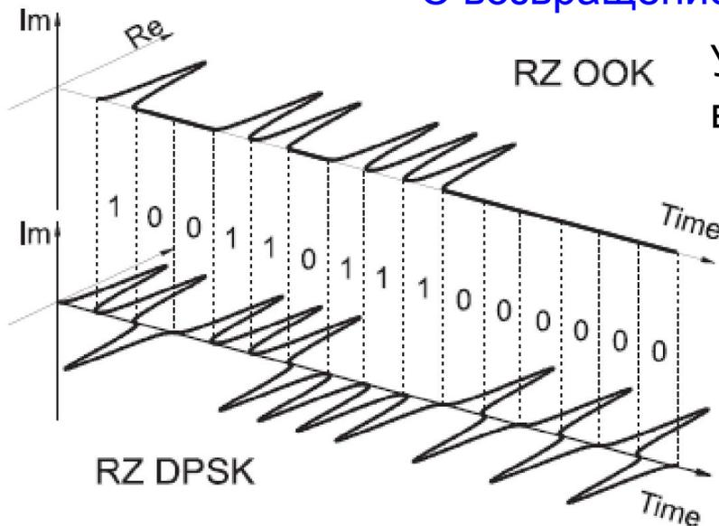
Уединенные импульсы более устойчивы к внутрисимвольным нелинейным искажениям
