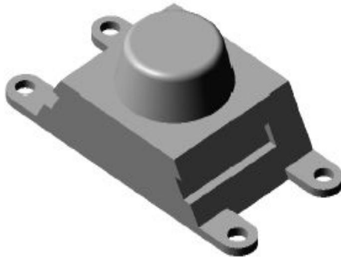
Рис. 76.7. Бобышка и лапки приклеены к основанию детали, пазы и отверстия — вырезаны
